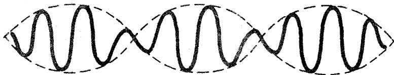
شکل ۱.۴ تغییر فضایی میدان الکتریکی دو موج اختلاف بسامد.
